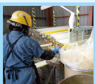
被膜付蛍光灯の場合は手作業で被膜をはがします。
