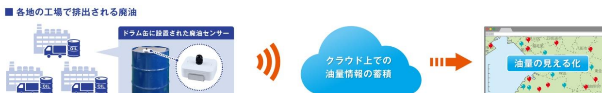
図1 油量の「見える化」の仕組み
